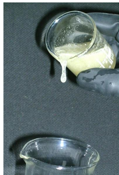
**Фото 2 Отклонитель на основе СУРФОГЕЛЬ® м.Е после гелирования**
